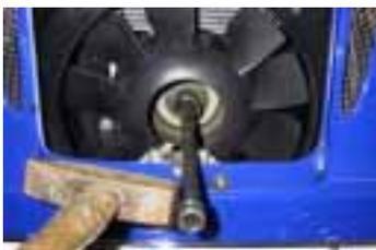
Die Riemenscheibe ist mittig mit einer Schraube gesichert. Sie müssen nun diese Schraube mit einer dünnwandigen 14 Nuss lösen. Blockieren Sie dazu mit einem Schraubendreher oder Meißel die Schwungscheibe an Zahnkranz!
